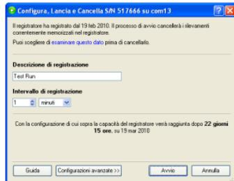
Una volta inserita una descrizione per l'esecuzione di registrazione e impostato l'intervallo di registrazione il registratore dati sarà pronto per l'uso. Cliccare sul tasto **Avvio** per iniziare a registrare.
